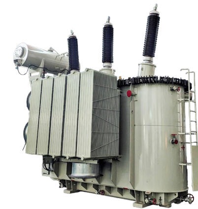
3-Phase 60 MVA AIS 150/22 kV YNyn0+d
